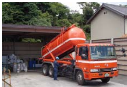
ローリー荷下作業 入荷した産廃は地下ピットへ投入
