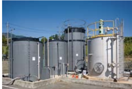
中和タンク 入荷した廃液を 中和タンクへ投入し 苛性ソーダまたは希硫酸により中和処理
