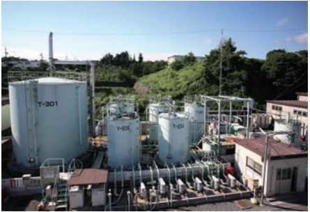
種別タンク・製品調合タンク 入荷した産廃を規定カロリーにブレンド
